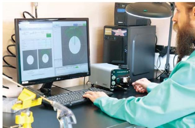
Соединители перед запуском в производство проходят проверку на программно-аппаратном комплексе контроля concentricity Koncentrik-V2 Ferrule+Connector компании Data-Pixel (Франция). По окончании процесса изготовления сборок соединители проходят на данном оборудовании оптимизацию оптических характеристик.
