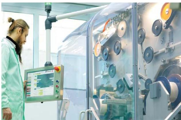
Отмотка кабеля заданными длинами осуществляется автоматически на высокоточном оборудовании производства компании Optogear (Финляндия).
