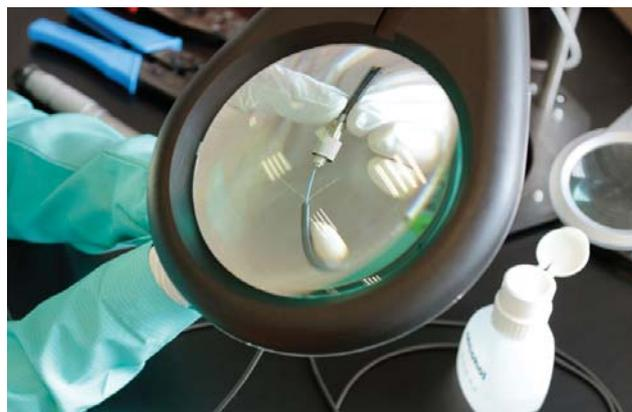
Монтаж соединителей на кабель осуществляется по «клеевой» (epoxy & polish) технологии. При заполнении соединителей клеем его необходимо дозировать с высокой точностью, обеспечивая воспроизводимый и повторяемый результат. Для этой цели используется специальный программируемый дозатор Термопро ND-35 V100 отечественного производства. Он позволяет максимально быстро заполнять заданное количество соединителей одинаковым объемом клея.
