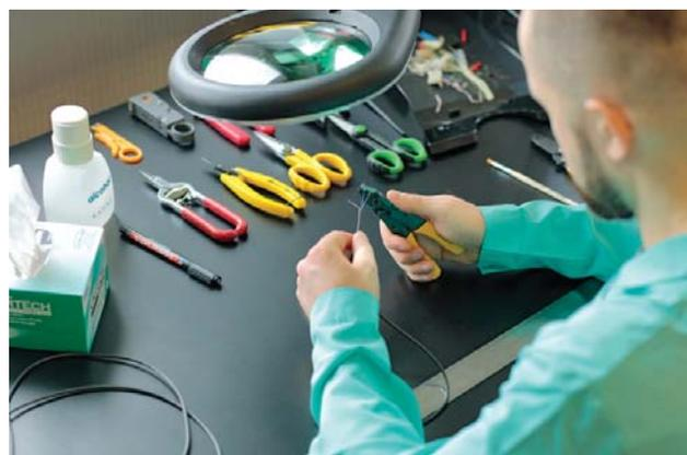
Специальные оптические кабели собственного производства, применяемые для изготовления сборок, часто имеют сложную конструкцию, не допускающую использования программируемых разделочных машин, и требуют разделки вручную. Для этих целей используется специализированный разделочный инструмент производства Miller (США) и HAUPA (Германия).
